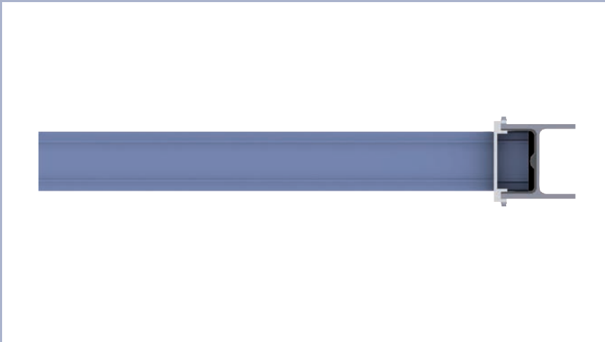
Bild 3: Cisilent®-Lärmschutzwand; Draufsicht Schallschutzelement
